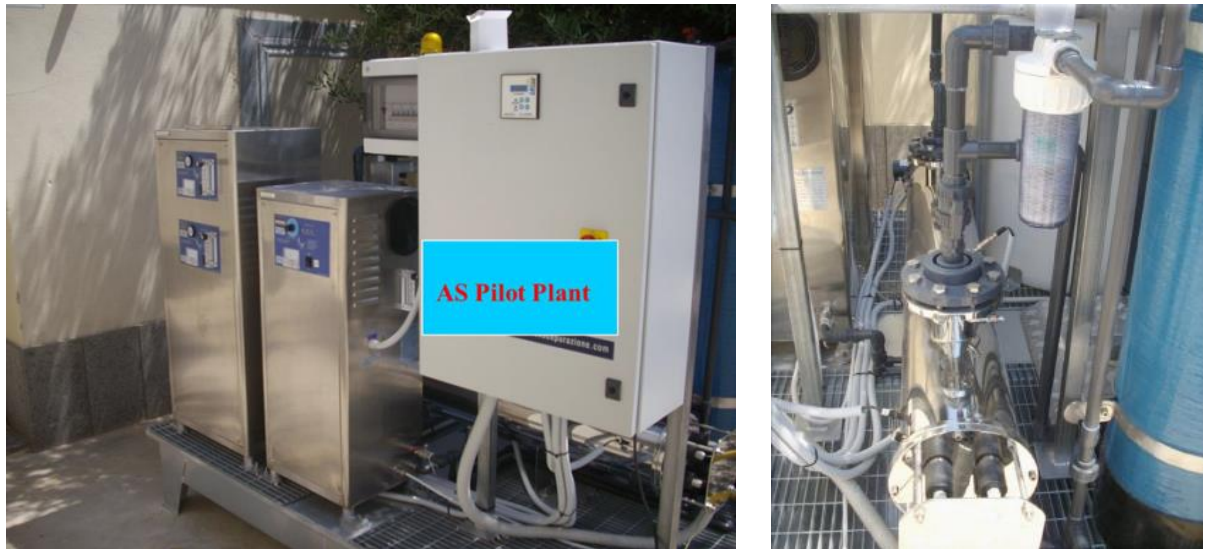
Figura 24: Impianto di Foto-ozonolisi in funzione presso Aero Sekur, Aprilia (LT)
